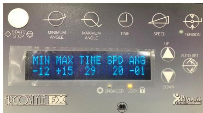
L'interfaccia utente di Auto-Flexion visualizza i parametri di Auto-Flexion correnti. La riga superiore visualizza il nome del parametro e la riga inferiore visualizza il parametro corrente.
