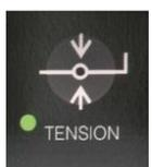
**Tensione:** Commuta il pedale di elevazione dalla modalità di elevazione alla modalità di tensione di flessione,
