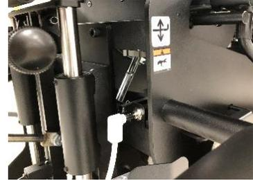
Testare l'interruttore paziente premendo il pulsante. Con il lettino in funzione, premendo una volta il pulsante si interromperà il trattamento, verrà emesso un segnale acustico costante, il lettino tornerà in posizione neutra e si fermerà. Il segnale acustico può essere interrotto premendo il pulsante Start/Stop, che interromperà il trattamento. Premendo e tenendo premuto il pulsante Patient Switch durante il segnale acustico costante si attiverà la Comfort Zone.
