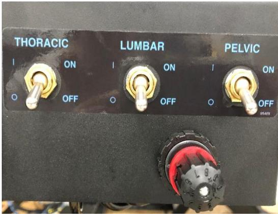
**Interruttori a levetta di armamento automatico:** Per armare una delle Drop (toracica, lombare, pelvica), posizionare l'interruttore a levetta in posizione ON e premere il pedale di controllo dell'armamento automatico. Per regolare la capacità di presa (tensione) della sezione di caduta, ruotare la manopola di controllo della tensione di caduta corrispondente per aumentare o diminuire la capacità di presa.
